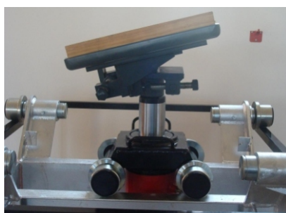
Přípravek pro mont. a demont. převodovky TR/P 800 - nosnost 800 kg
