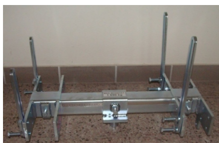
Přípravek pro montáž a demontáž filtrů pevných částic pro vozy SCANIA
