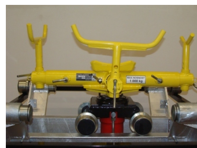
Přípravek pro mont. a demont. převodovky TR/P 1000 - nosnost 1000 kg
