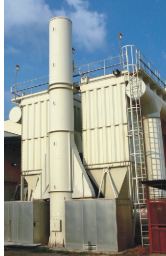
odprašení výroby umělého kamene filtrační výkon 85 000 m 3 /h
