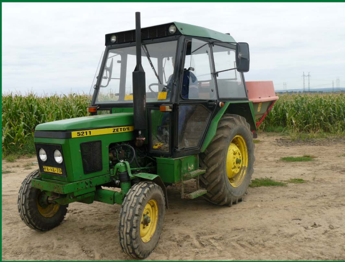
Zetor 5211 se sypačem na sůl
